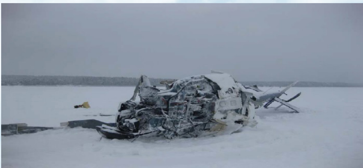
Хвостовая балка в районе 4-го шпангоута разрушена при столкновении.
