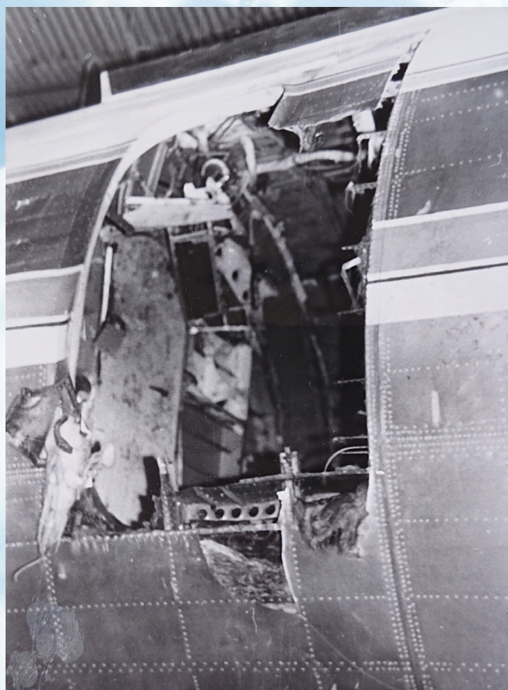
Общий вид вырва конструкции фюзеляжа в зоне передней входной двери
